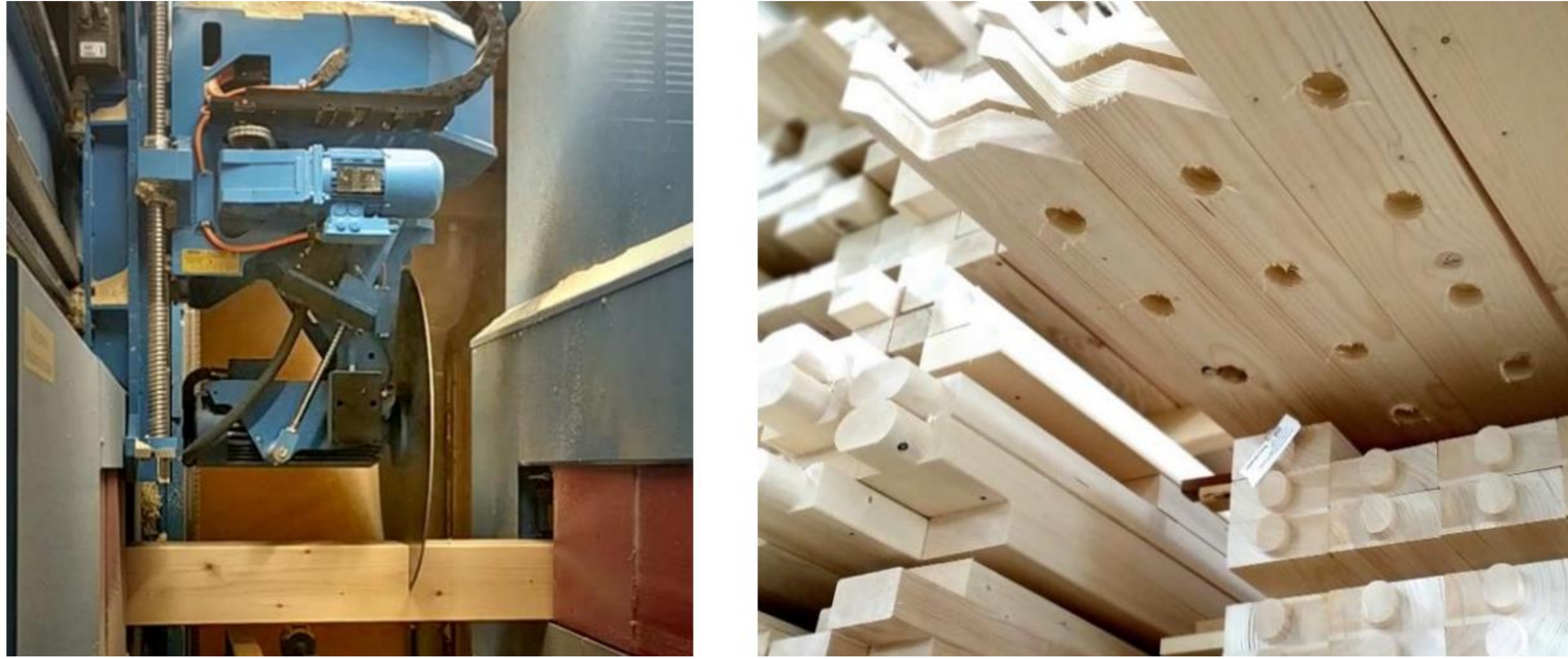
Abb. 01: Das Aggregat einer Abbundanlage (links) sowie die fertig bearbeiteten Holzbauteile (rechts) bedeuten eine wesentliche Veränderung im Handwerk von Zimmerleuten.
